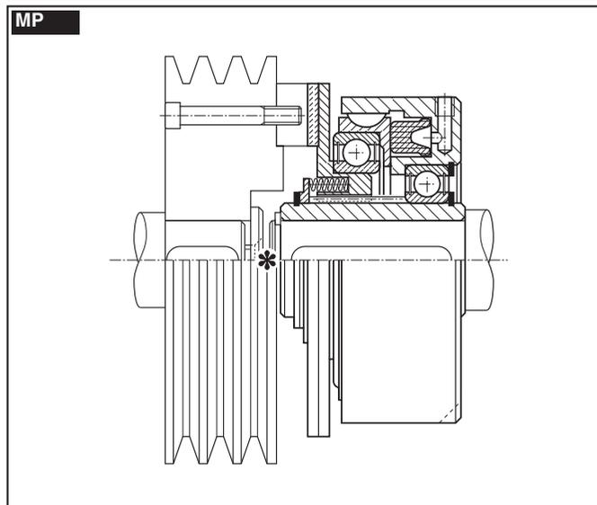
**PNEUMATIC SINGLE PLATE DRY OPERATING CLUTCH**
