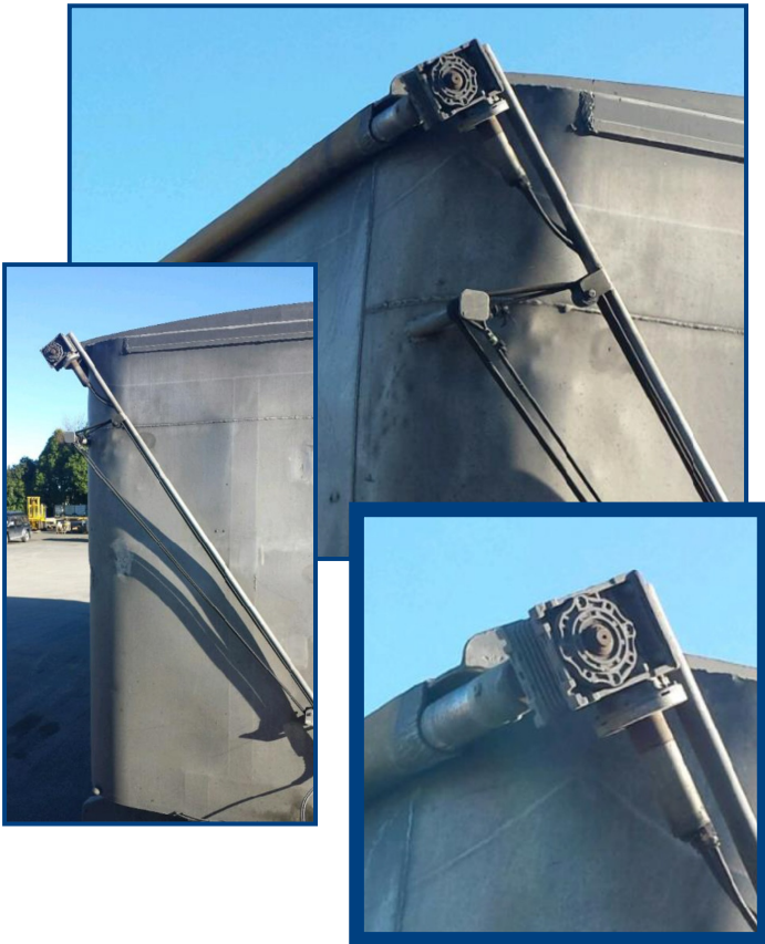
Motor reductor neumático reversible del tipo MT05 de 150W y un reductor.
